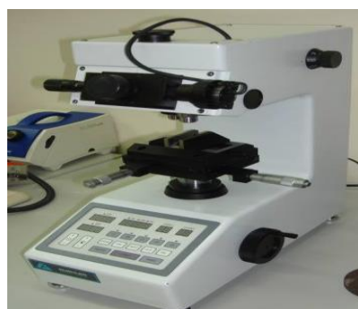
Hình 2.2. Máy đo độ cứng tế vi dưới tải trọng nhỏ
