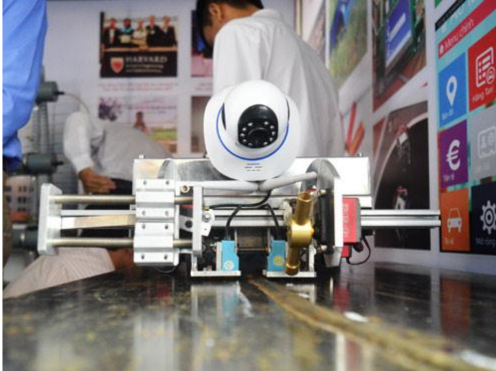
Robot có kích thước tương đối nhỏ gọn, với đầu dò siêu âm và tích hợp camera ghi nhận hình ảnh
